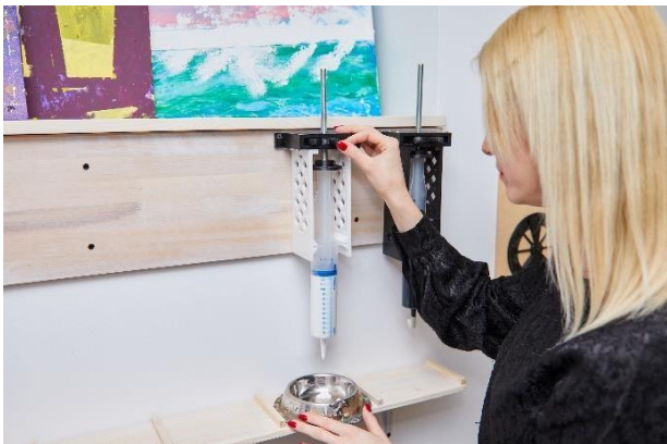
Рисунок 2 – Система дозирования краски
